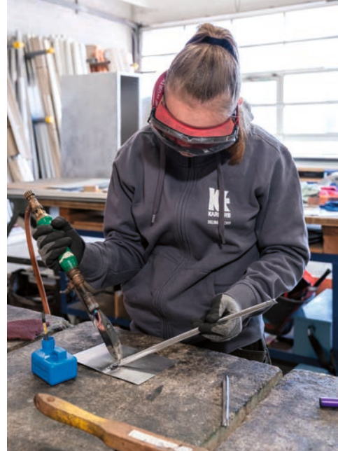
^ Die Lernende lötet die Bleche so, dass sie dicht sind und kein Wasser eindringen kann.
