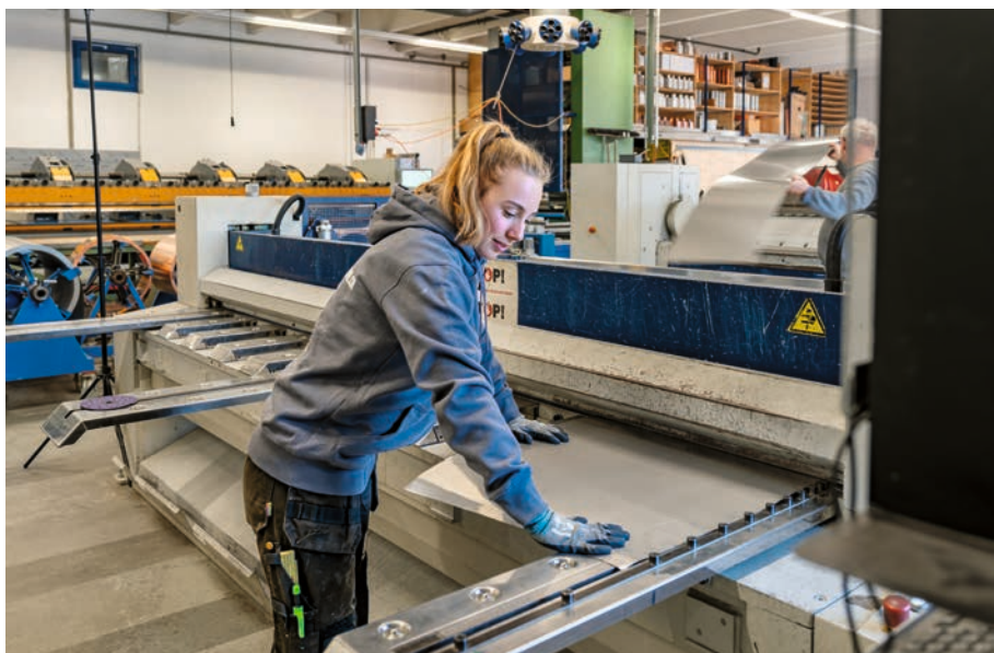
^ Bevor Selina Flacher die Bleche biegt, schneidet sie diese an der Tafelschere, einer speziellen Schneidmaschine.
